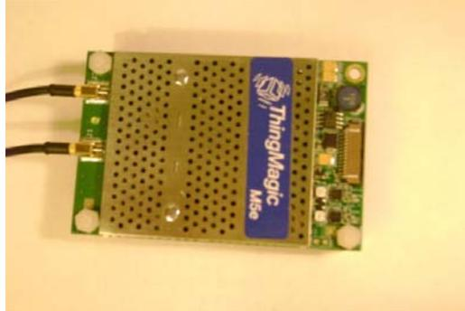
Figure 4.5 Mercury Thing Magic 5e RFID Readers
